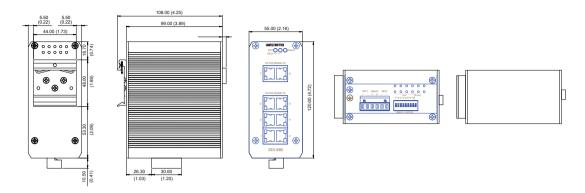
$\textbf{Dimension W} \textbf{ x} \textbf{ H} \textbf{ x} \textbf{ D} \quad 55 \text{ mm} \times 120 \text{ mm} \times 108 \text{ mm}$
